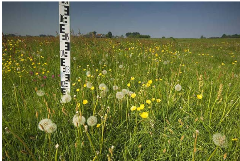
Voorbeeld van vegetatiestructuurmeting met behulp van een baaklat. Met deze lat wordt de hoogte gemeten waarop de lat juist zichtbaar is.
